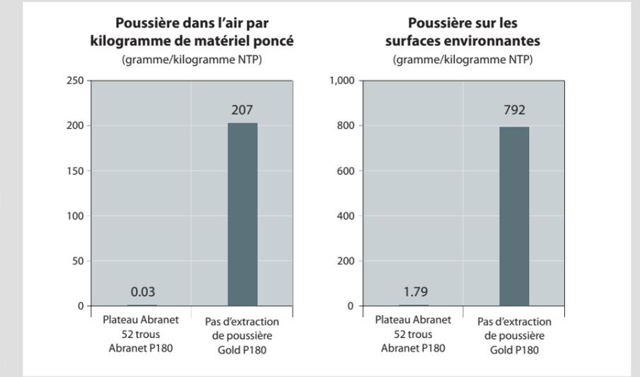
**LAUREAT DES TESTS.** Des tests en laboratoires montrent que l'Abranet résout les problèmes liés à la poussière. La concentration de particules en suspension dans l'air lors du ponçage est 6900 fois inférieure avec l'Abranet par rapport à l'utilisation d'abrasifs classiques.
